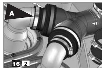
Déclipser le capot. Dévisser le collier **16** du moteur défectueux (le clapet anti-retour reste en position lors du dépannage du moteur).
